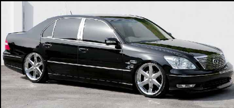
CELSIOR UCF30/31MC後 20 INCH F.8.5J +40 R.9.5J +38 TIRE F.245/35-20 R.275/30-20 FRONT SPACER 5mm・ローダウン・リアフェンダーを加工してあります。
